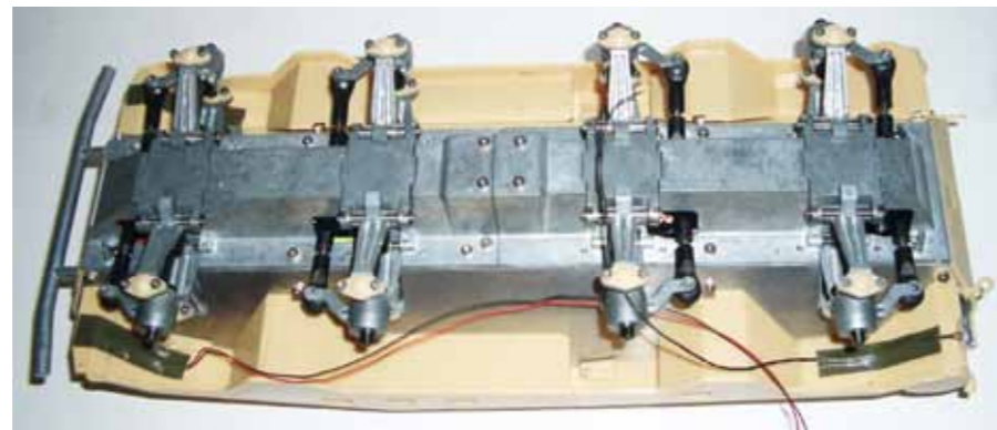
Die Radkästen sind so gefertigt, dass sie sich an die Schräge des Chassis anpassen
