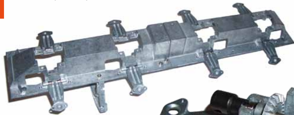
Die Unterwanne nach den ersten beiden Bauabschnitten. Montiert sind der vordere Spant und die oberen Radaufhängungen
