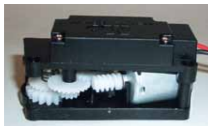
Der Turmdrehantrieb ist fertig und bereit für den Einbau auf der Innenseite der Oberwanne
