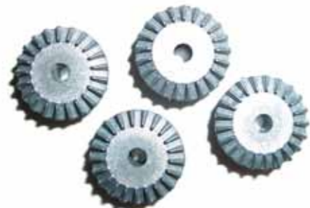
Diese Kegelzahnräder sind für den Antriebsstrang bestimmt und aus Aludruckguss gefertigt. Hier wären Zahnäder aus einem haltbarerem Material im Antriebsstrang wohl besser geeignet
