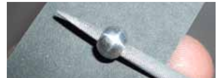
Da die Kugeln sich in den Augen der Lenkstangen schwer bewegen lassen, werden die einzelnen Kugeln auf eine Schlüsselfeile gesteckt, welche in eine Akkubohrmaschine eingespannt wird. Anschließend werden sie auf einer 1.000er-Polierleine poliert
