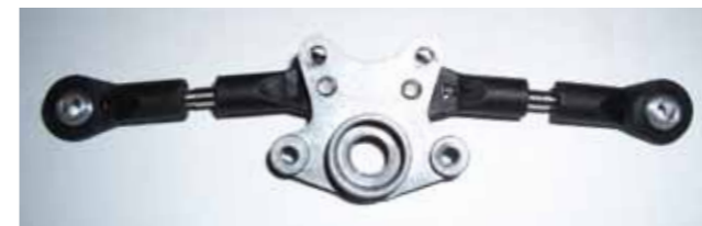
Die beiden mittleren Achsanlenkungen erfahren eine Änderung durch Versetzen des Lenkgestänges um 5 Millimeter hin zum Drehpunkt. Dies verbessert die Lenkgeometrie des Modells und das Fahrverhalten
