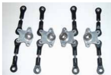
Die vier Anlenkungsbauteile für die Allradlenkung sind bereit für den Einbau in der Wanne. Auch hier kommt im Drehpunkt je ein Kugellager zum Einsatz
