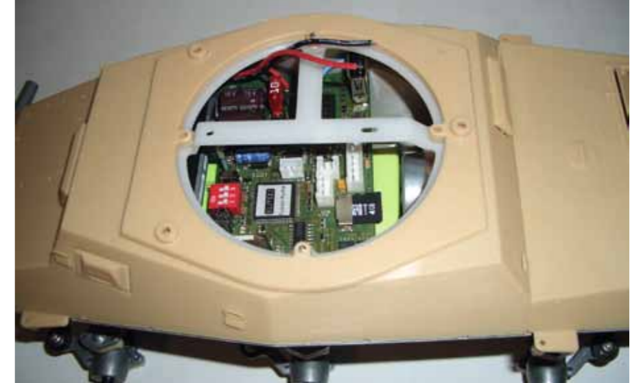
Das FO-Modul darf im Modell probesitzen: der einzige Platz dafür ist unter dem Turm und da geht es sehr eng zu. Das Servo für die Rohrrelevation kann nicht auf der Unterseite des Stegs im Turmdrehkranz verschraubt werden
