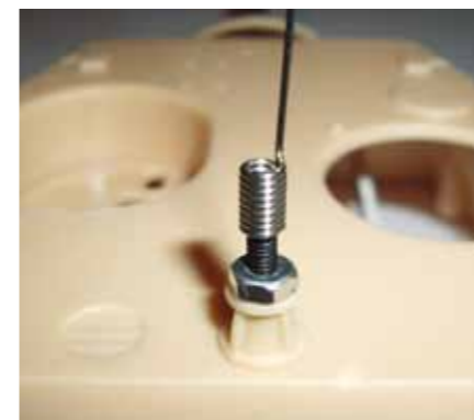
Die Antennenverbindung des Baukastens ist zu klobig und passt nicht sehr gut zu dem Modell. Sie wurde durch einen Eigenbau ersetzt
