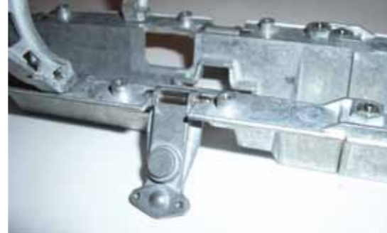
Die oberen Radaufhängungen sind mit Stahlachsen in der Unterwanne eingehängt und durch die aufgeschraubten Halter der Federung sind die oberen Radaufhängungen sicher in der Wanne befestigt
