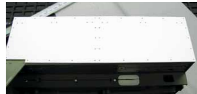
Die selbstgefertigte Bohrschablone für die Seitenwände
