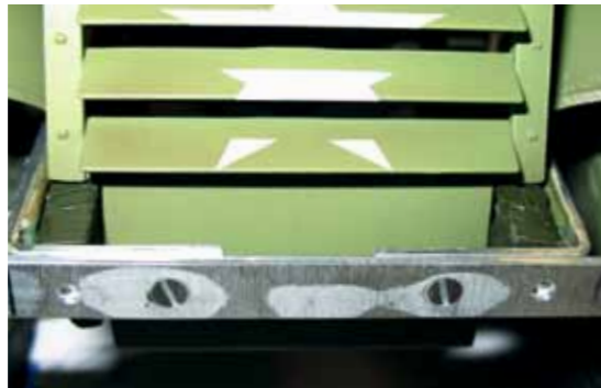
Die Schraubenköpfe werden dauerhaft eingeklebt. Auf die neue Stoßstange wird noch die Grabenrolle montiert
