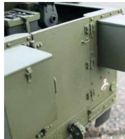
Die Scharniere an der Hecktür und am Turmschutzschild wurden mit Hilfe von M1,4-Schrauben befestigt
