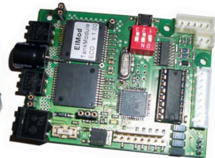
Mit den Abmessungen 72 x 54 Millimeter ist das ThinkTank Panzermodul ECO sehr kompakt und lässt sich problemlos ins Modell einbauen
